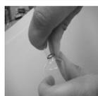
Com a ponta do dedo polegar fazer apoio no estrangulamento. Com o dedo indicador envolver a parte superior da ampola (balão), pressionando-a para trás.
